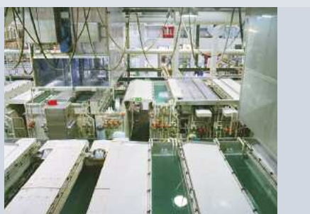
Abb.12: Oberflächenveredelungs- anlage im neuen Werk Fronhausen: Vorbild für die Forschungsanlagen (Quelle: Seidel)
