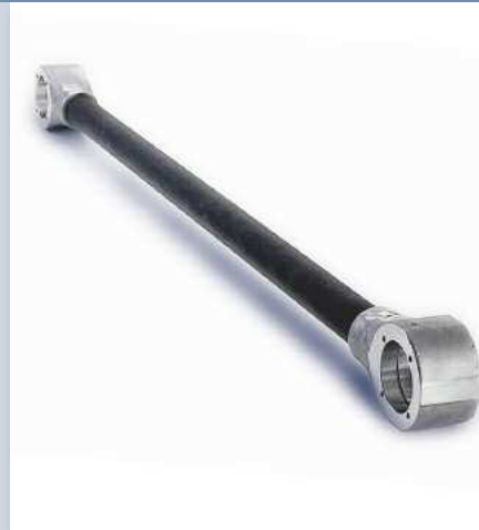
Abb. 23: Kohlenstofffaserverstärktes Kohlenstoff (CFC)-Heizelement für den Einsatz im Vakuumofen. Für Bauteile zur Anwendung bei extremen Temperaturen (bis 2700 °C, im Vakuum oder unter Schutzgas) bieten CFC-Werkstoffe eine sichere Lösung. (Quelle: Schunk)
