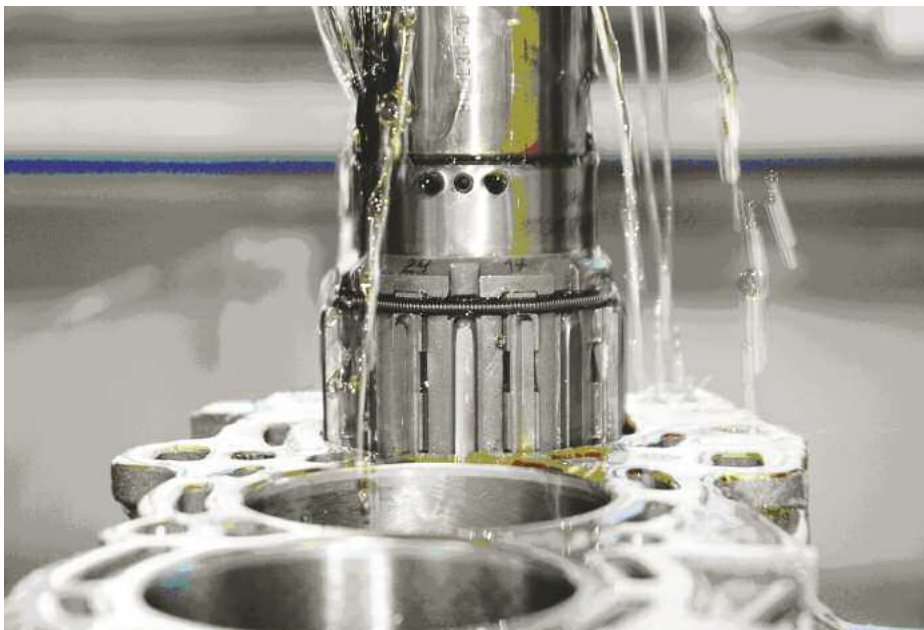
Abb. 3: Honen von thermisch gespritzten Schichten in der Zylinderlaufbahn (Quelle: Fa. Gehring)
