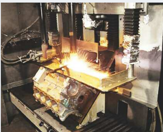
Abb. 4: Nanokristalline PTWA-Beschichtung (Plasma Transfer Wire Arc, thermisches Fülldraht-Spritzverfahren im Plasmaprozess) eines Motor-Blockes (Quelle: Fa.Gehring)
