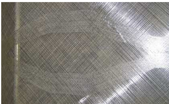
Abb.10: Gelege mit Kettfadenversatz und Kettfadendichteänderung (Quelle: CETEX)
